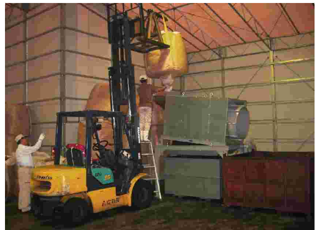
小型トロンメルの設置例 選別物：食品残渣
