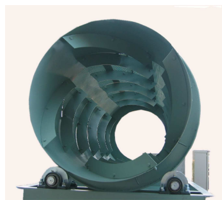
オーバー材出口 1000φドラムに 送り羽根機構
